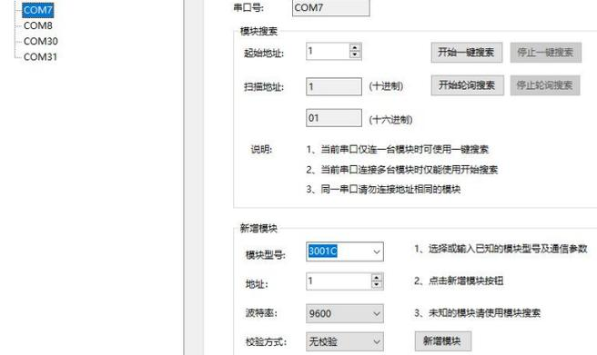
1、**模块搜索**用于搜索的模块信息（设备型号、通信地址、波特率、校验方式），其中开始一键搜索是软件向模块发送万能搜索指令（模块固件版本需在 B0.01及以上，并且同一串口上仅能连接一台模块），此功能可直接获取到模块的信息，开始轮询搜索是从起始地址开始轮询搜索模块信息（支持所有固件版本，且同一串口上可连接多台通信地址不同的模块），直至搜索到地址为255时自动停止，停止搜索是在轮询搜索过程中提前停止搜索，搜索到的模块信息将显示在串口号下方，如上图所示，信息内容分别是：设备型号、通信地址、波特率、校验方式；
