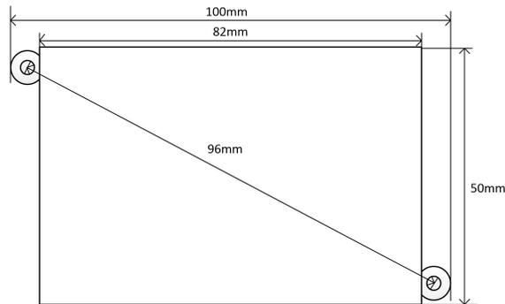
备注: 高度32mm, 对角安装孔直径4mm
